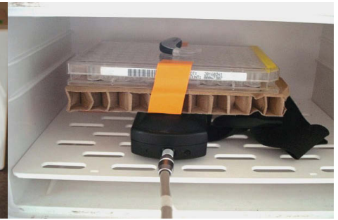
Abb. 1: Definierte Versuchsanordnung zur Messung des Abstrahlverhaltens (Fernfeld, links) und der spezifischen Absorptionsrate (SAR) im Nahfeld (rechts). Das Hörgerät befindet sich im linken Bild hinter der Kulturschale, das zweite Hörgerät befindet sich im rechten Bild unterhalb der Kulturschale direkt auf dem Dosimeter.
