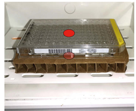
Abb. 2: Anordnung der 96-Loch-Kulturplatte im Inkubator für die Zellexposition. Die beiden roten Punkte bezeichnen die Lage der beiden Hörgeräte.
